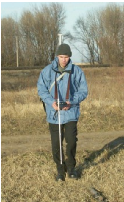
Рис.3. Бесконтактное магнитометрическое обследование газонефтепроводов, расположенных под слоем грунта
